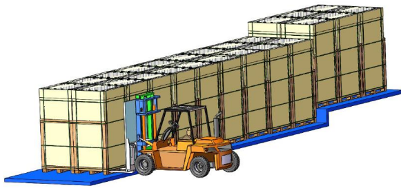
Entladen von längsseitigen vertikalen Verpackungen mit einem Gabelstapler
