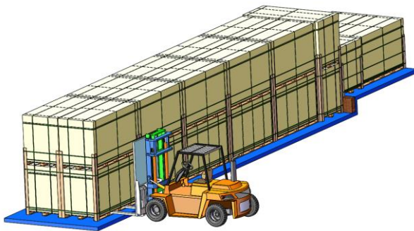
Entladen von kurzseitigen vertikalen und U-förmigen Verpackungen mit einem Gabelstapler
