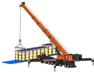
Entladen von längsseitigen vertikalen Verpackungen mit einem
